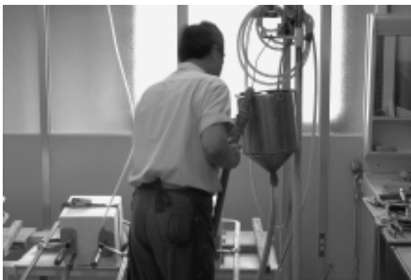
（写真9）泥しょうの鑄込み作業
