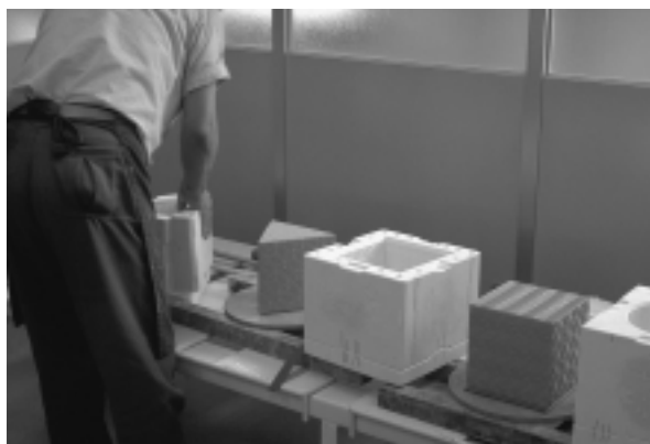
（写真10）排泥の後，石膏型から出す．
