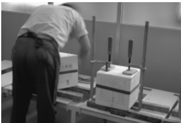
（写真8）石膏型組み立て作業
