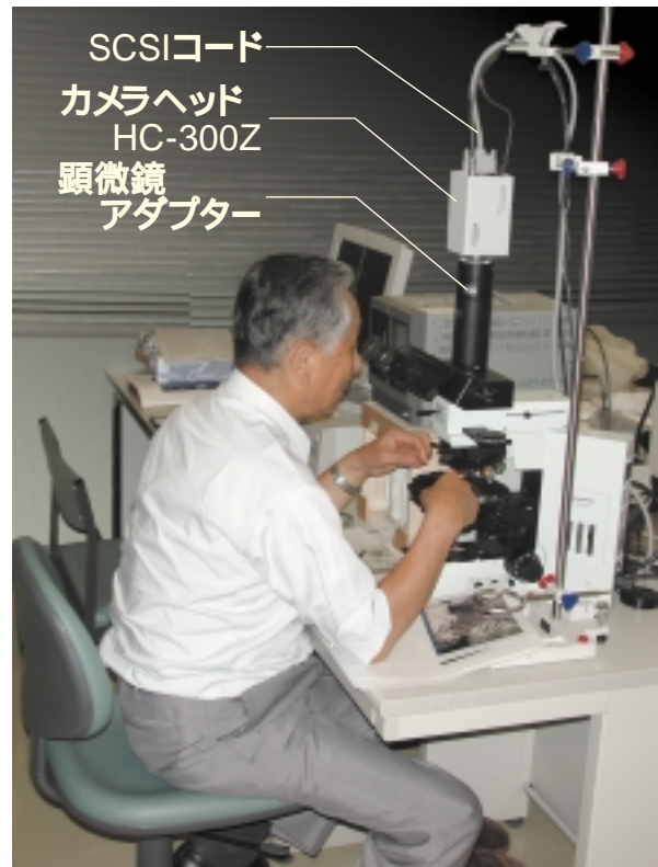
(図-1) デジタルカメラと偏光顕微鏡: デジタルカメラは顕微鏡アダプターを介して、鏡筒に取り付けられる。カメラ本体からは各種のコードが出ているが、これらは鏡筒の方向に上へ少し延ばした後、スタンドで一度固定される。SCSIコードは太くて重い。これらのコードはモニターやMOディスクドライバーにつながれている。そのままでは鏡筒は下側方へ引っ張られる。その結果、鏡体に力が加わって、光軸が歪む。これを防ぐために鏡筒上部で固定するのである。MOディスクドライバーは隠れて見えないが、モニターとパソコンの一部がこの写真に写っている。
