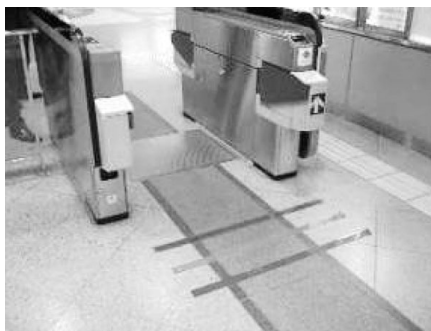
写真1 駅構内にカラーテープを貼って、スマートフォンで色認識の確認
